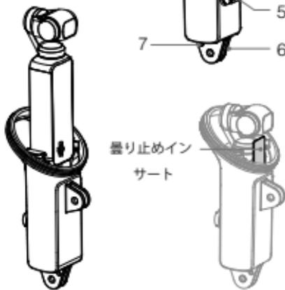
2. Osmo Pocket の電源を切り、図のように防水ケースに入れて、曇り止めインサート（付属品）を取り付けます。
