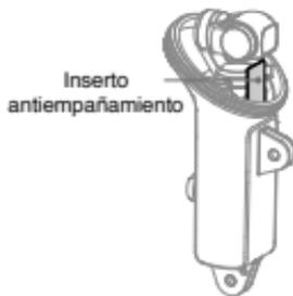
2. Apague el Osmo Pocket, colóquelo en el estuche impermeable como se muestra y coloque el inserto antiempañamiento (incluido).
